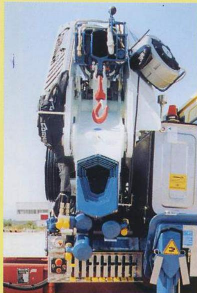
· Compattezza: 25,76 m di braccio idraulico 28 t\*m di capacità' in uno spazio di 1x2.5x2.2 m
