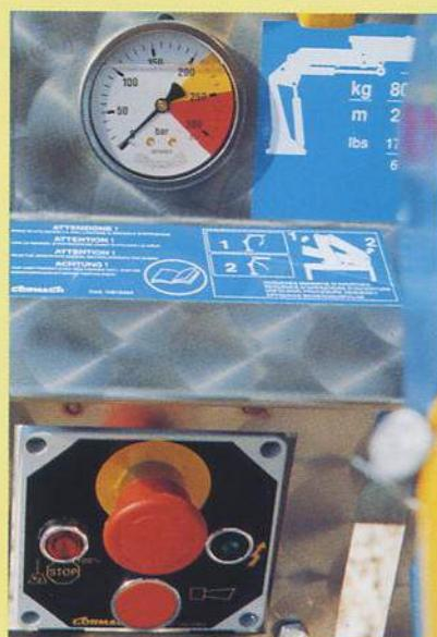
· Indicatore dello stato di carico con evidenziate le zone di preallarme e allarme come richiesto dalle normative internazionali.
