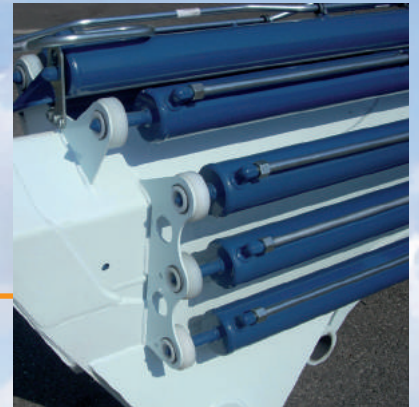
Attacchi cilindri snodati Moving cylinders connections Bewegliche Zylinder Halterungen Fixage de vérin basculant
