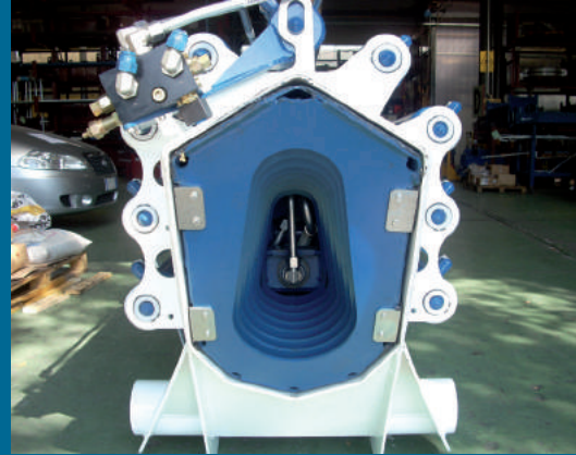
Sezione poligonale delle prolunghe, sistema CORMACH The boom extension with polygonal structure, CORMACH design Polygonal Ausschube, CORMACH System Bras a structure polygonale, Système CORMACH
