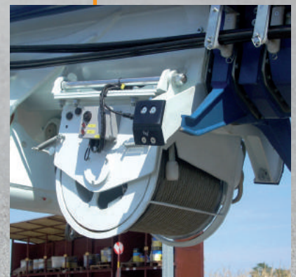
Verricello tiro diretto 4000 daN - (OPZIONE) (2500 daN con JIB) 4000 daN (2500 daN with JIB) winch on first line - (OPTIONAL) Treuil de tir direct 4000 daN (2500 daN avec JIB) - (OPTION) 4000 daN (2500 daN JIB) Winde am ersten Seil - (AUF FRAGE) Cabrestante tiro directo 4000 daN (2500 daN JIB) - (BAJO PEDIDO)
