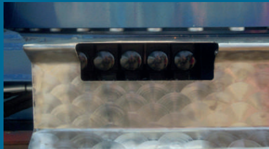
Comandi di Emergenza degli Stabilizzatori Stabilizers Emergency controls Not Bedienung der Stützen Commande d'urgence de Stabilisateurs
